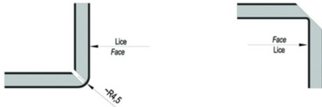
Izrada žljeba za savijanje pod uglom 90° V- Shaped Groove for 90° folding
